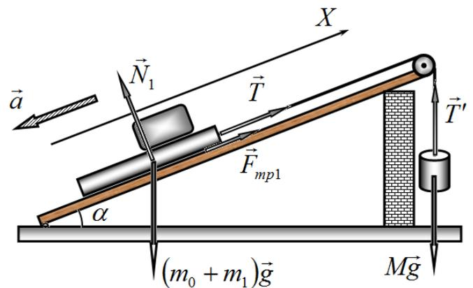
Тогда на основании 2 закона Ньютона можно записать уравнения для описания движения поддона с полезным грузом в проекции на ось  $X$  :
