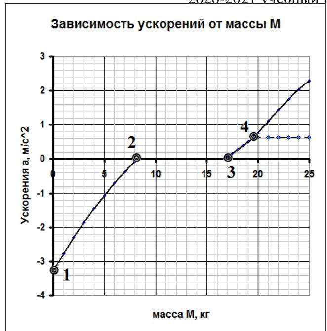
2. Графики полученных зависимостей показаны на рисунке. Пунктиром обозначен участок графика зависимости ускорения ящика, когда оно отличается от ускорения поддона.
