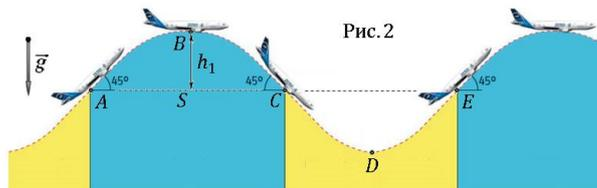
**1.3** Поскольку на участке  $ABC$  самолет выключает двигатели (Рис. 2) и переходит на параболическую траекторию, то его движение ничем не отличается от движения камешка, брошенного под углом к горизонту (Рис. 3).
