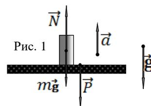
Как следует из (3) лифт может двигаться в любом направлении (опускаться, ускоряясь или подниматься, замедляясь), но с ускорением  $a_1 = g$ , направленным вниз. При этом его пассажиры испытают кратковременную невесомость. Простейший вариант – свободное падение на небольшом промежутке времени (не более нескольких секунд!).
