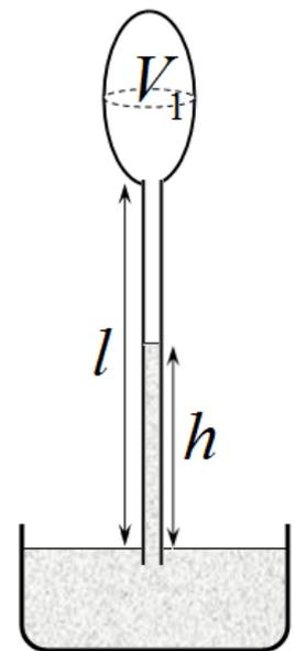
$h = 0$ . При остывании уровень воды в трубке повышается, тем самым данный прибор можно использовать в качестве комнатного термометра.
