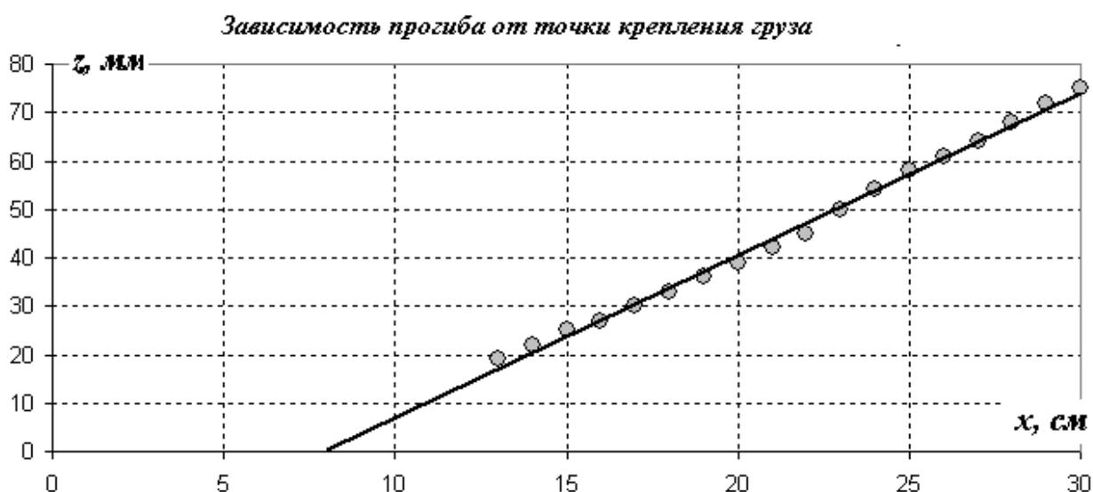
Следует отметить, что прямая не проходит через начало координат. Из полученной формулы (1) следует, что при  $x = 0$  (т. е. когда груз отсутствует) отклонение стержня должно быть положительным – экспериментальные данные противоречат этому выводу!
