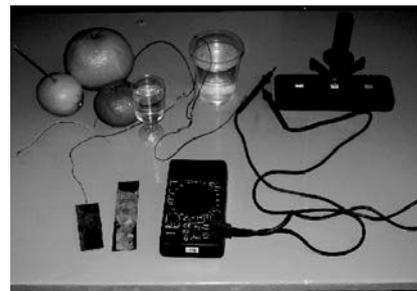
Между двумя разными металлами, помещенными в электролит, возникает гальваническая ЭДС. В качестве электролита могут выступать и фруктовые соки. Изучение «фруктовых» гальванических элементов является основной целью данного экспериментального задания.
