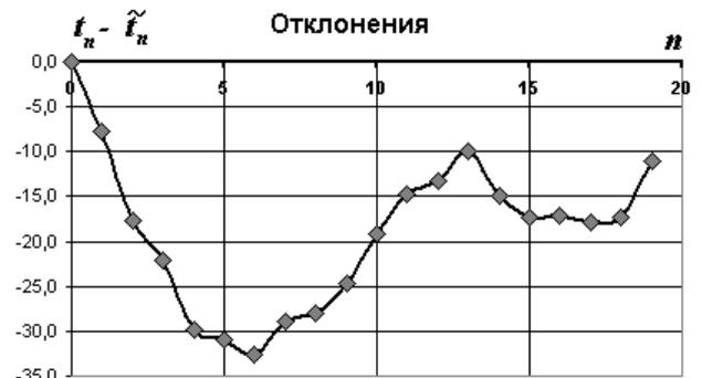
Красиво – «на глаз» линеаризованная зависимость массы от времени почти идеальна. Но на графике зависимости отклонений от номера капли видно, что все они в одну сторону. А численные параметры: время таяния  $T = 7598c \approx 2 \text{ часа}$ , среднеквадратичное отклонение  $s \approx 21c$  – не много, особенно на фоне 2000 с.
