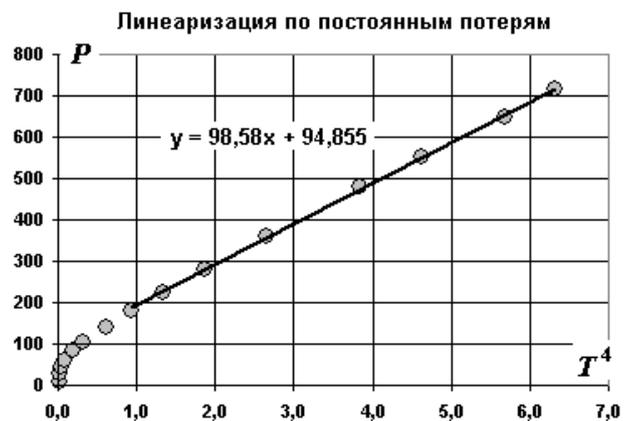
Как все знакомо – точки низких температур отклоняются, а при видимом накале нити ровненько укладываются на ожидаемую прямую, параметры которой рассчитываются с помощью двух клавиш! Какой показатель степени в радиационных потерях получается в этом приближении? Логарифмический масштаб, параметры линейной зависимости, готово! Показатель – чуть больше четырех (думаю в пределах погрешности – четыре); свободный член – близок к полученным ранее.
