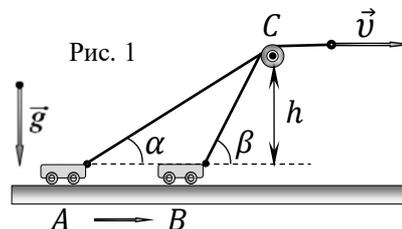
$$v_{\text{ср}} = \left( \frac{\frac{1}{\tan 35^\circ} - \frac{1}{\tan 65^\circ}}{\frac{1}{\sin 35^\circ} - \frac{1}{\sin 65^\circ}} \right) \cdot 1,5 \text{ м/с} = \{2,254070734\}^1 = 2,3 \text{ м/с}. \quad (8)$$
